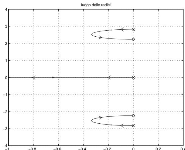
Figura 2: Contorno delle radici del sistema  $G_2(s)$  al variare del parametro  $K_v > 0$  quando  $\mathbf{a} = 3$  e  $\mathbf{a} = 5$ .
