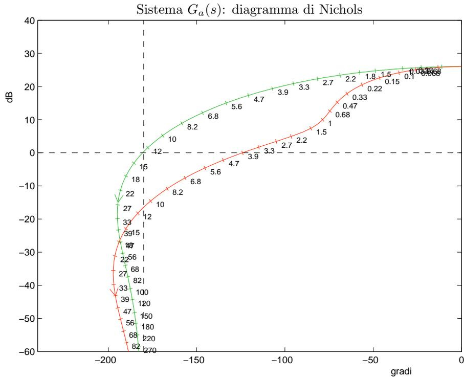
Figura 3: Diagrammi di Nichols delle funzioni  $G_a(s)$  e  $C_1(s)G_a(s)$  per  $\mathbf{a} = 3$ .
