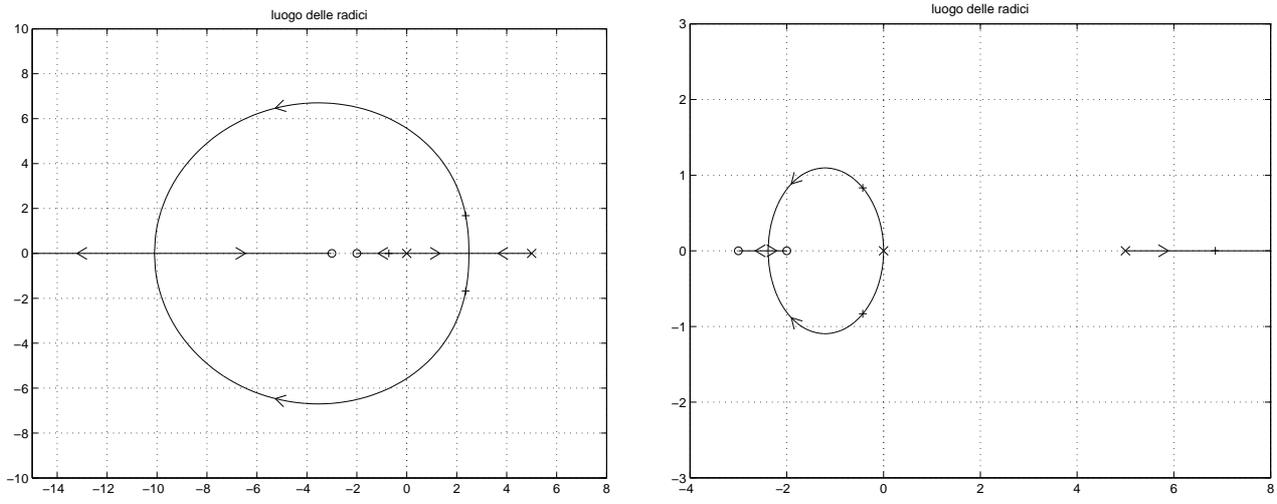
Figura 1: Luoghi delle radici del sistema  $G_1(s)$  al variare di  $K_1 > 0$  e di  $K_1 < 0$  quando  $\mathbf{a} = 3$  e  $\mathbf{b} = 5$ .
