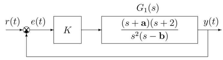
Tracciare qualitativamente il luogo delle radici del sistema retroazionato al variare del parametro  $K$ . Tracciare il luogo delle radici sia per  $K > 0$  che per  $K < 0$ . Determinare esattamente la posizione degli asintoti, le intersezioni  $\omega^*$  con l'asse immaginario e i corrispondenti valori del guadagno  $K^*$ . Determinare la posizione dei punti di diramazione "solo in modo qualitativo".
