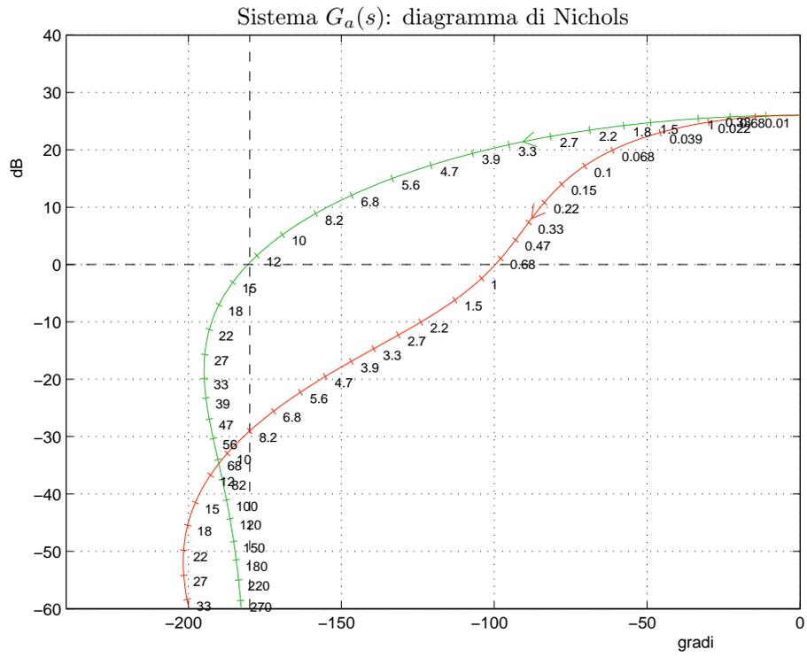
Figura 4: Diagrammi di Nichols delle funzioni  $K G_a(s)$  e  $K C_1(s) G_a(s)$ .
