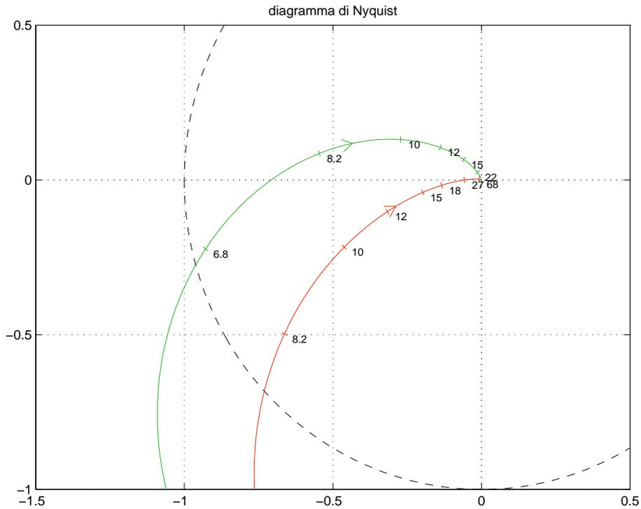
Figura 5: di Nyquist delle funzioni  $G_b(s)$  e  $C_3(s) G_b(s)$  per  $a = 3$ .
